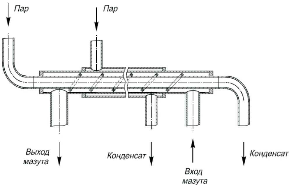
Подогреватель ПМ-0,75 состоит из одной секции. При работе мазут поступает в межтрубное пространство, вращается между витками проволоки и обогревается паром с двух сторон. Пар попадает по трубам и в виде конденсата отводится в расширитель.
